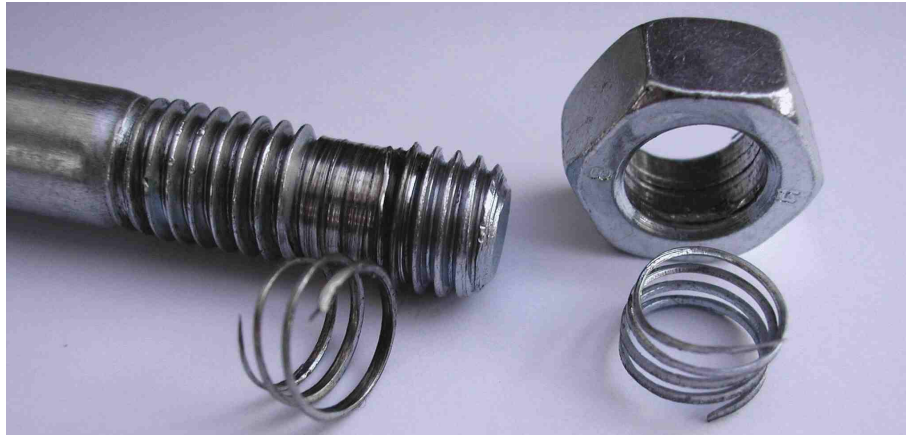
Figuur 1.8 Schroefdraadafschuiving opgetreden bij een belasting boven de proefbelasting waaraan de schroefverbinding moet voldoen.
